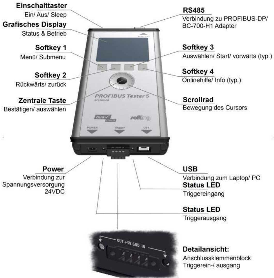
Abbildung 10: Anschlüsse, Bedienelemente und Statusanzeige des BC-700-PB
