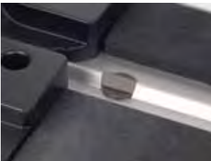
Brechkegel für gerade Schnitte
