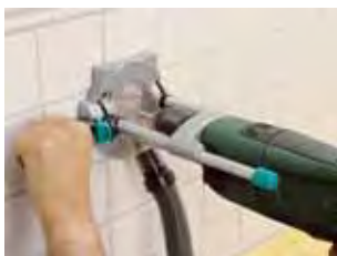
Zusatzhandgriff für punktgenaues Ansetzen und gegen Verrutschen beim Bohren
