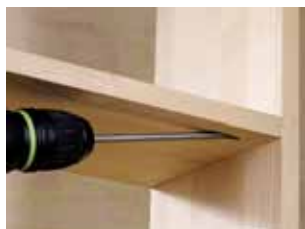
... anschließend verbinden Sie die beiden Werkstücke mit Holzschrauben ...
