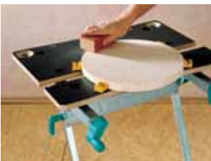
Kunststoffbacken zum Flachspannen
