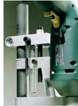
Bohrtiefeinstellung durch Tiefenstopp
