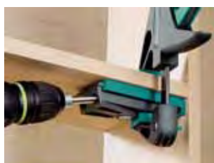
Mit dem Undercover Jig bohren Sie präzise Löcher in das Werkstück...
