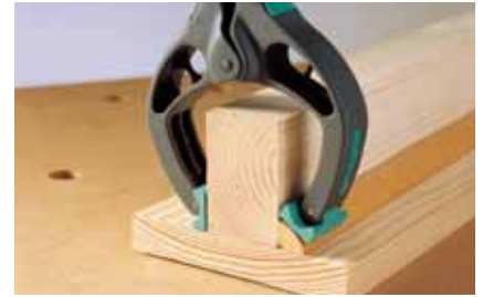
bewegliche Spannbacken passen sich dem Werkstück an
