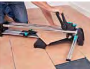
spezielle Führung für Diagonalschnitte
